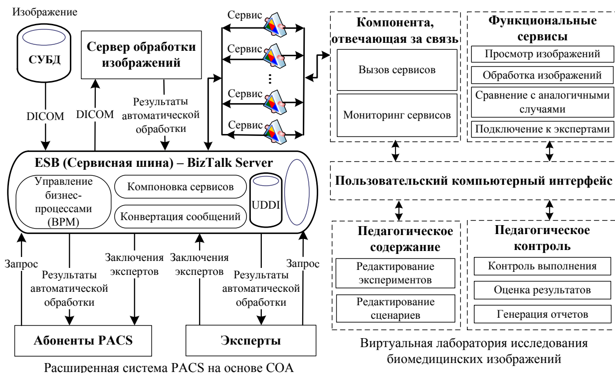
Рис. 3. Структура виртуальной лаборатории и ее взаимодействие с APACS
